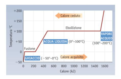
Figura 6.11 Trasferimento di calore e la variazione di temperatura dell'acqua. Questo grafico mostra la quantità di calore acquisita da 500 g d'acqua in seguito alla variazione di temperatura da -50°C a 200°C
