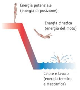
**Figura 6.4** La legge di conservazione dell'energia. L'energia potenziale del tuffatore viene convertita in energia cinetica ed energia termica.
