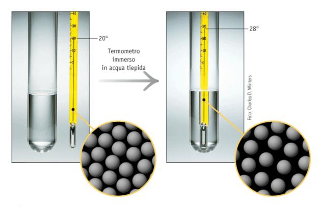
**Figura 6.5 Misura della temperatura.** Il volume del mercurio liquido contenuto nel termometro aumenta leggermente quando questo viene immerso in acqua tiepida. L'aumento di volume causa un aumento del livello del mercurio nel tubo del termometro, che è calibrato al fine di indicare la temperatura.
